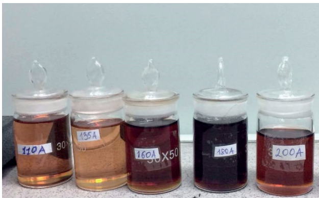
Рис. 4 – Ряд цветового изменения насыщенности растворов фуллеренов, полученных при значениях постоянного тока 110 – 200А
