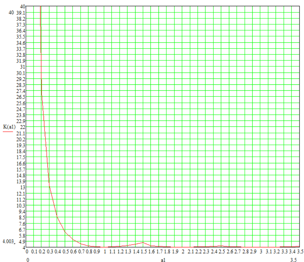
6 сурет – Жақтары топсалы бекітілген пластинаның орнықтылығының күдікті жүктеме параметрі
